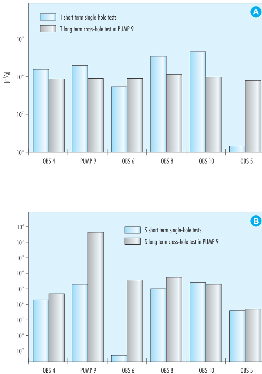
Figura 7.3. Resultados de los valores de parámetros estimados en los ensayos de corta (a) y larga duración (b) en la zona de cizalla de Grimsel.
