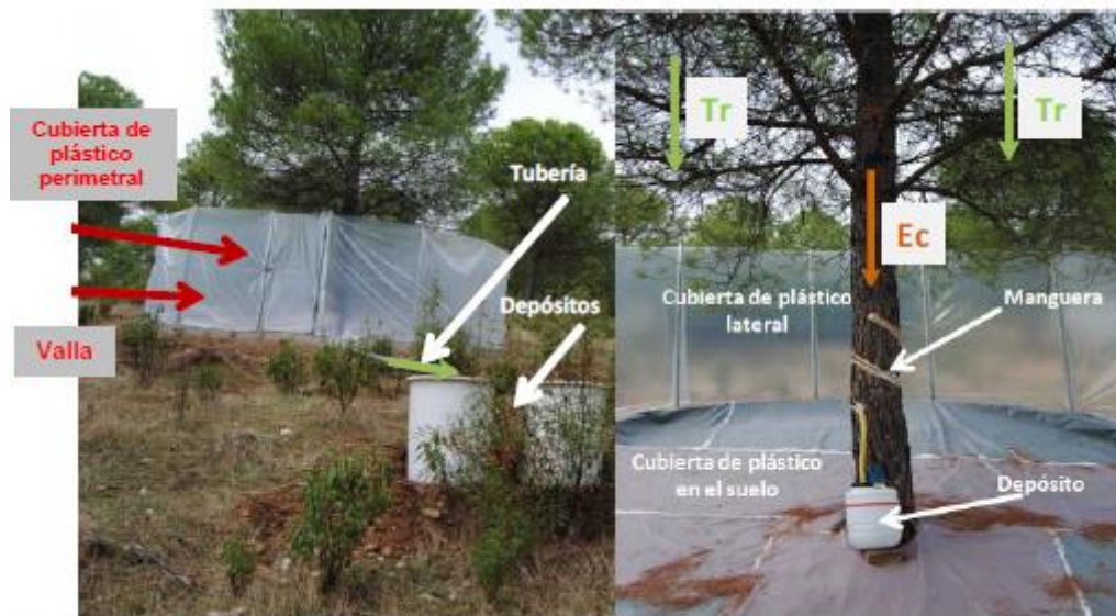
Figura 5-46: Infraestructura experimental instalada en la Cantera de los Palos (C.A. El Cabril) para medir la escorrentía cortical (Ec) y la trascolación (Tr)
