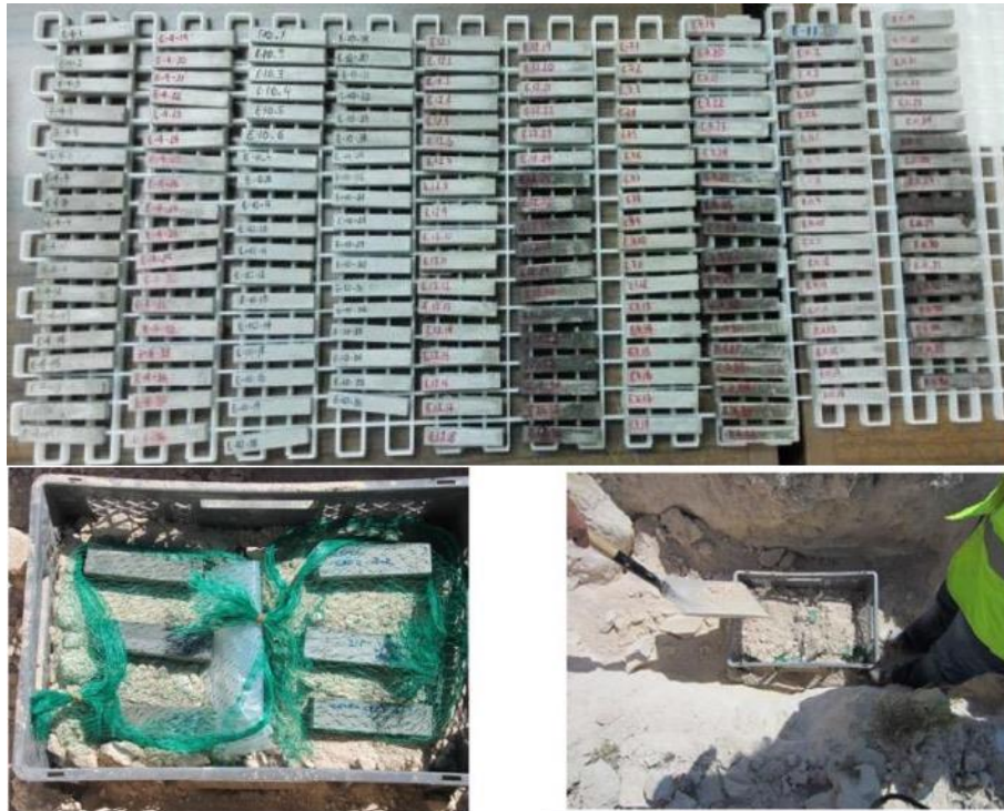
Figura 5-21: Probetas preparadas para el estudio de hormigones para el ATC, abajo, probetas de hormigón enterradas dentro del recinto donde se construirá el ATC para el estudio de la influencia del terreno
