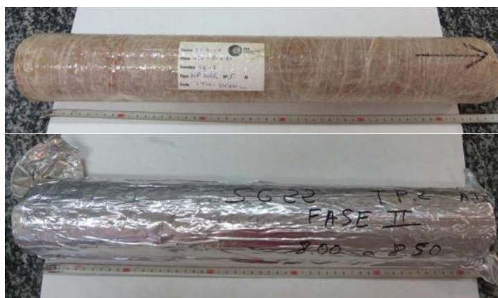
Figura 5-18: Testigos de sondeos practicados en Villar de Cañas preparados para su envío al laboratorio
