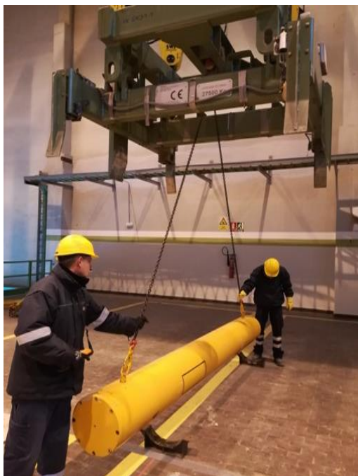
Figura 3-28: Contenedor de transporte para residuos de alta actividad
