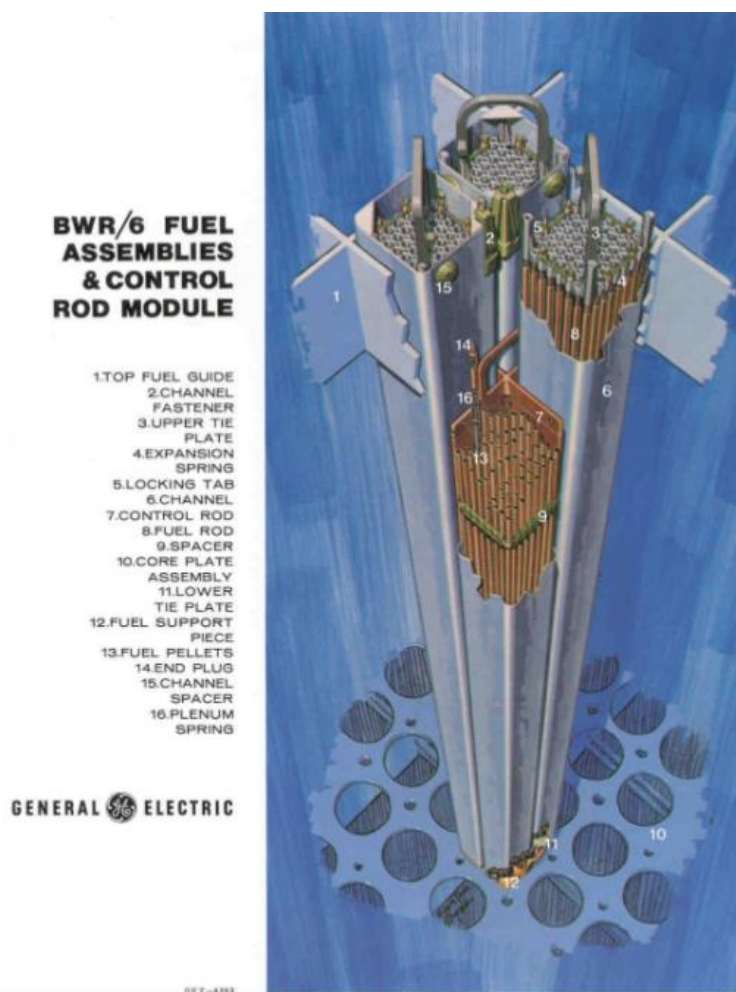
Figura 5-6: Esquema típico de elemento de combustible para reactores de agua en ebullición (BWR) [https://www.slideshare.net/myatom/bwr-fukushima]
