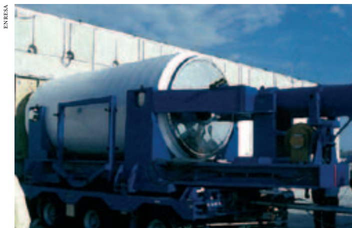
Figura 8. Instalación de almacenamiento temporal en nichos. A la derecha, introducción de un contenedor.
