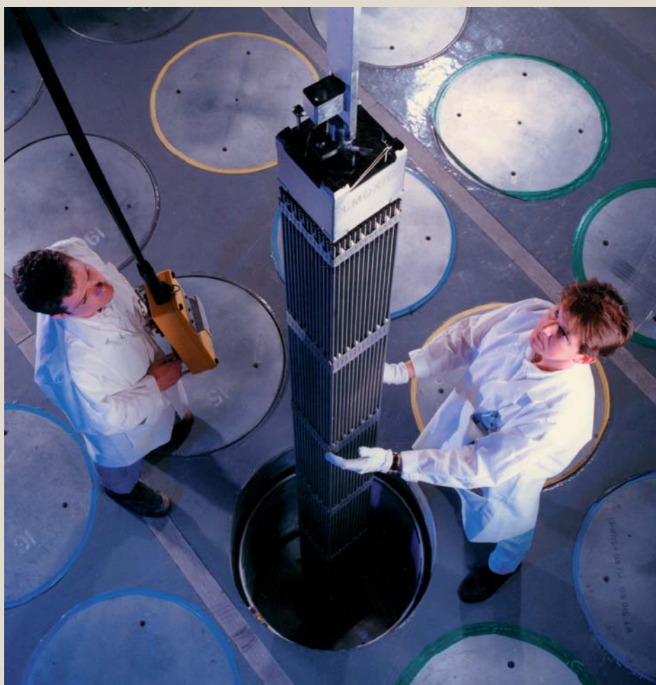
Pruebas de almacenamiento de elementos combustibles.
