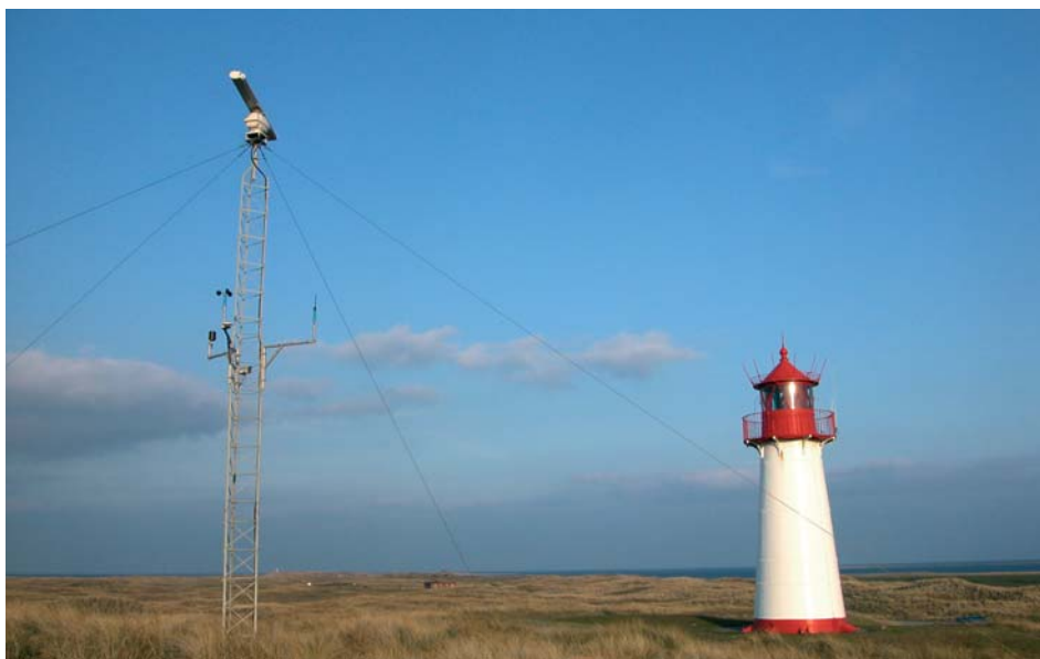
Radar de la red de Cosyna que detecta los movimientos de las olas.
