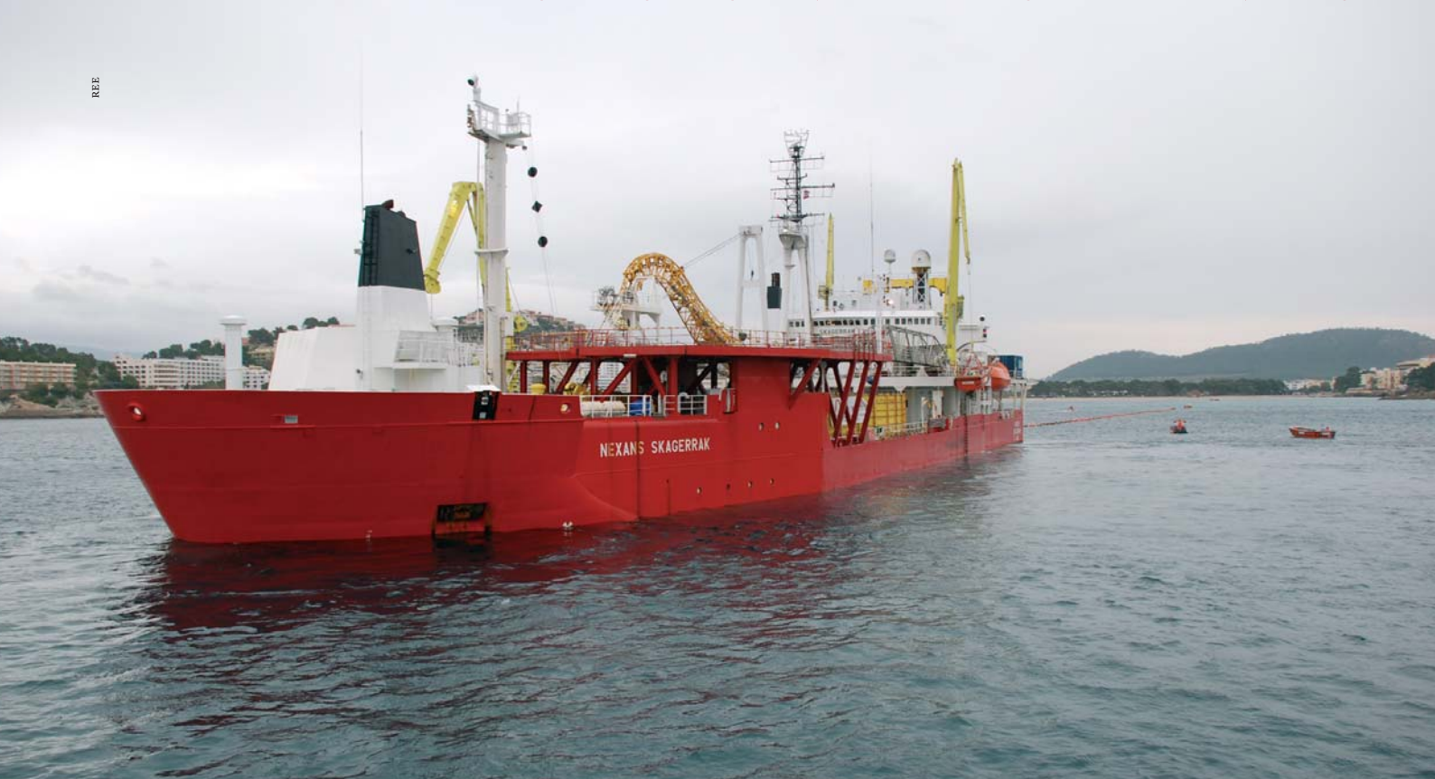
El Skagerrak es uno de los dos barcos que ha llevado a cabo el tendido de la conexión submarina entre la Península y Baleares.
