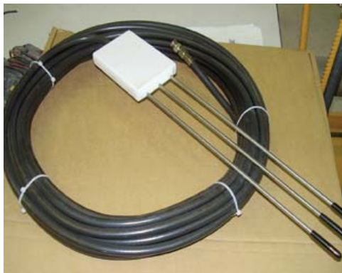
Los sensores instalados permitirán obtener información del comportamiento de las capas de cobertura.
