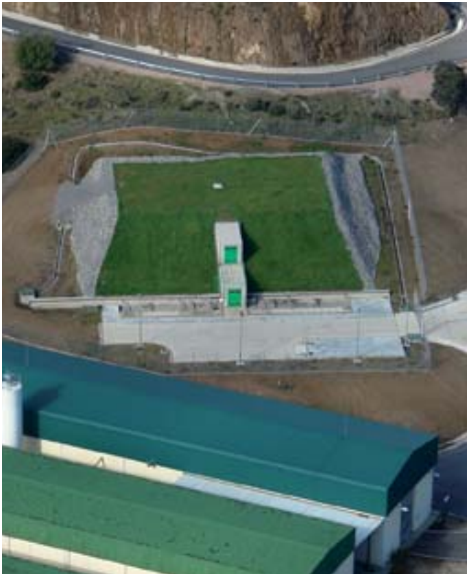
Vista aérea de los dos ensayos, que están separados por una galería donde se encuentra el sistema de adquisición de datos, cuya entrada se muestra arriba.
