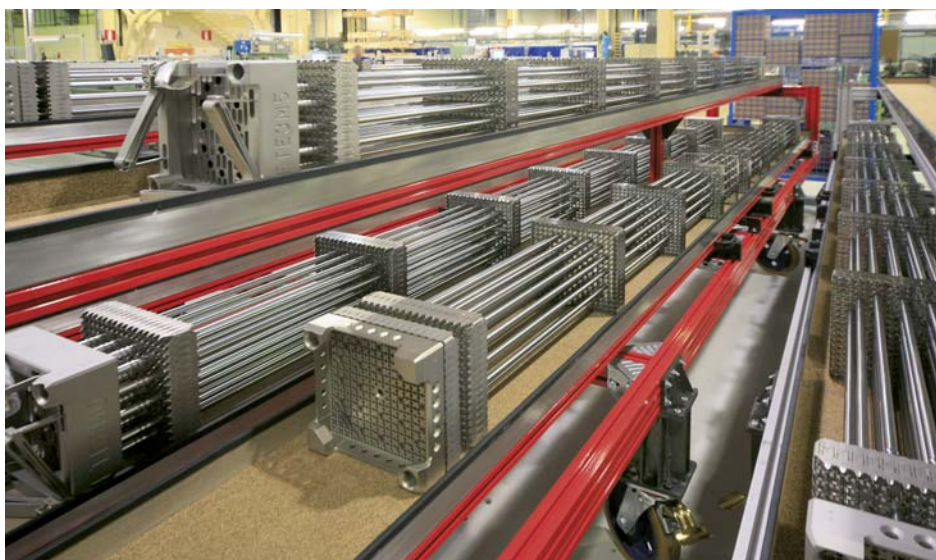
Montaje de los elementos combustibles.
