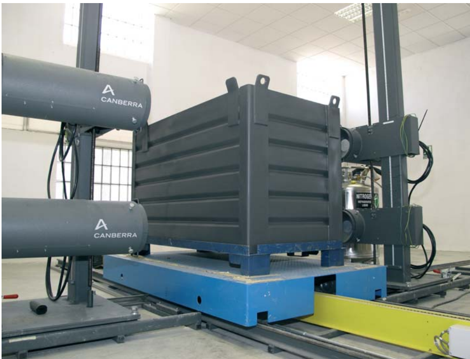
Medidor de bajo fondo box counter, empleado en el desmantelamiento.
