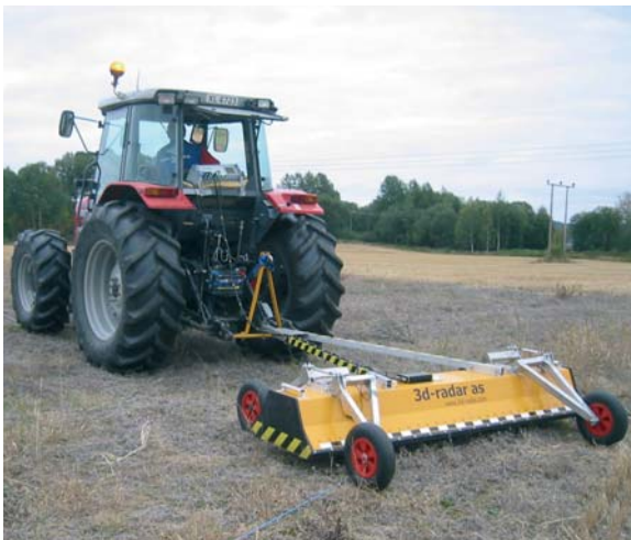
La señal de los radares GPR rebota contra objetos enterrados e indica la profundidad a la que se encuentran.
