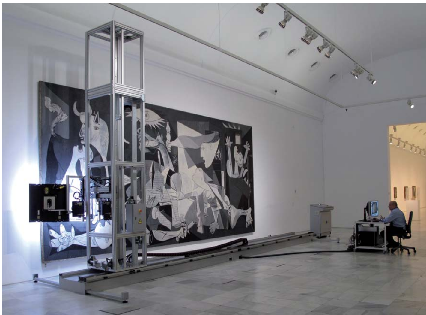
Hasta julio, las entrañas del Guernica , de Picasso, serán analizadas en el Reina Sofía por un robot de eje cartesiano, formado por sensores y cámaras con el último grito en luz visible, infrarrojo multispectral y escaneado en tres dimensiones.
