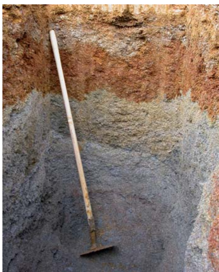
Figura 2. Precipitados de sulfato-hidróxidos de hierro (color rojo superior) y de aluminio (color blanco inferior) en una balsa de infiltración rellena de una mezcla de calcita y virutas de madera en Mina Esperanza, Huelva.
