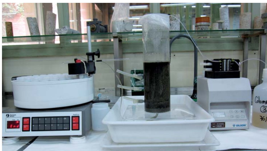
Figura 5. Montaje de una columna de experimentación. De derecha a izquierda, depósito de agua de entrada, bomba peristáltica, columna y muestras de agua de salida.
