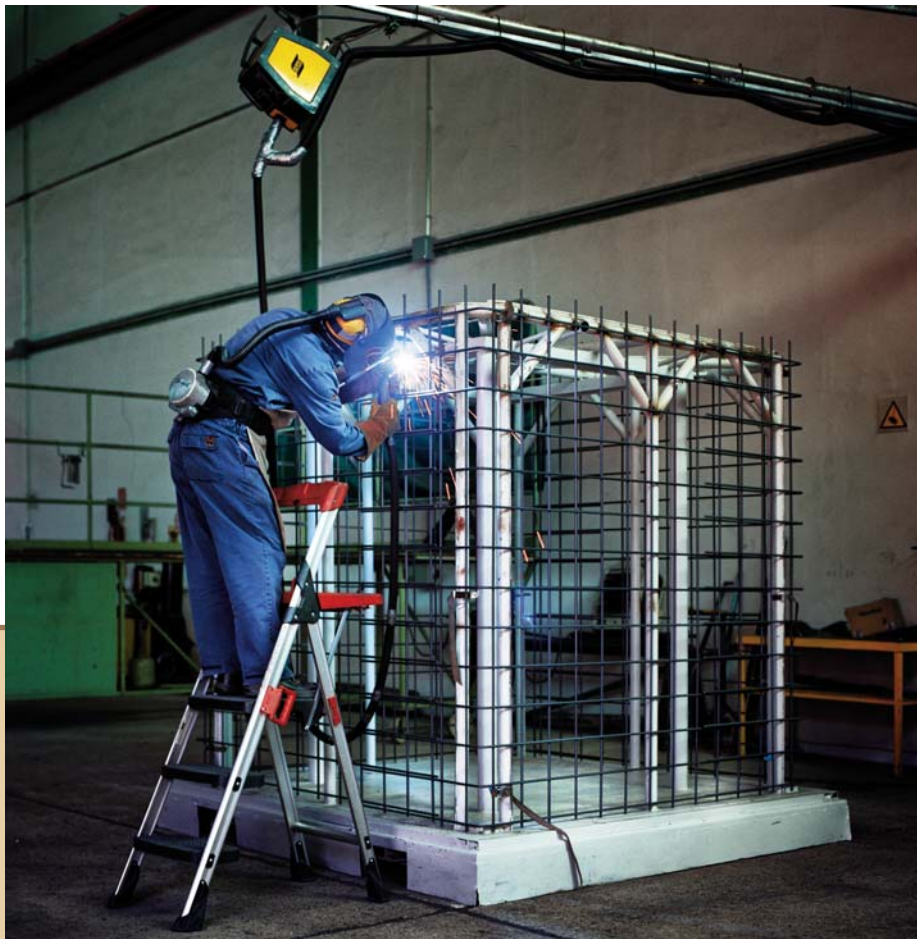
Construcción del armazón metálico de un contenedor.
