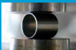
Ensayo de compresión anular.
